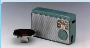
東京通信工業(現ソニー) 開発のトランジスタラジオ「TR-55」に信濃音響のG-205スピーカ(2.5インチ)が採用された
