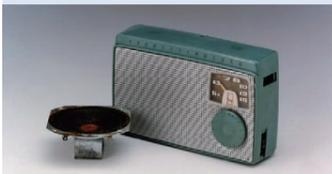
東京通信工業(現ソニー)開発の世界初のトランジスタラジオ「TR-55」に信濃音響のG-205スピーカ(2.5インチ)が採用された
